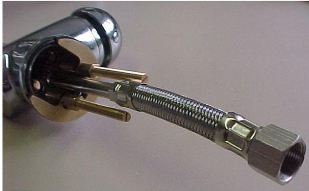
**4-** Enrosque el flexo al mango de ducha mediante la tuerca cónica y hágalo pasar por el interior del tubo desde arriba hasta conseguir que salga por la zona baja del grifo ("entre los pernos y la conexión). Estire con suavidad hasta que el mango de ducha quede encajado con la pestaña sita en el caño a tal efecto (puede que deba ayudar con la mano este último movimiento).
